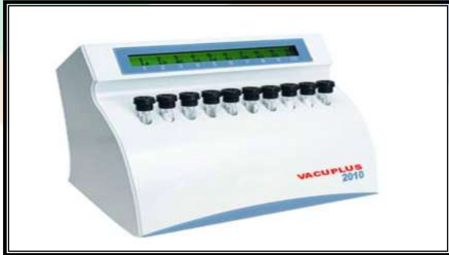
صورة توضح جهاز عداد معدل ترسيب كريات الدم الحمراء عوضاً عن الطريقة اليدوية القديمة
